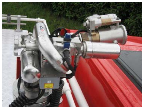
Lance Monitor POK télécommandée DN 65
