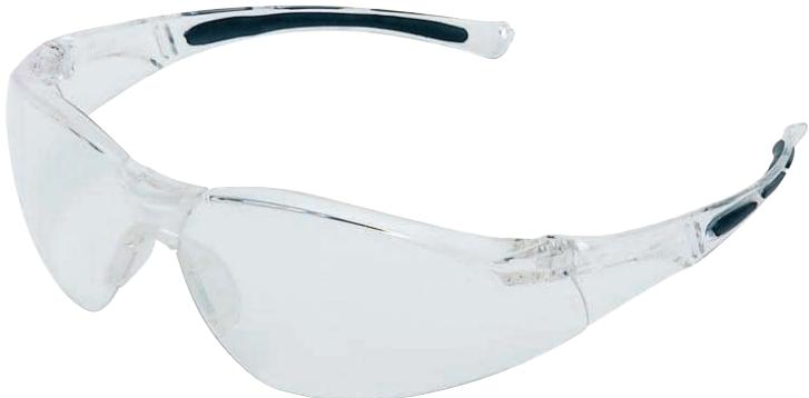
Oculaires renforcés en polycarbonate base 9 procurant un champ de vision à 180° sans déformation ; Bloquent 99,9% des UV Pont nasal souple anti-glissoir s'adaptant à de nombreuses conformations nasales ; Disponible avec une couche dure anti-rayures ou un revêtement anti-buée \*
