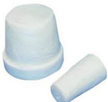
Pour usage unique. Conçu pour travailler avec des échantillons de microbiologie, de culture cellulaire... S'ajuste parfaitement au col des récipients. Stérilisable à 200°C. Perméable à l'air.
