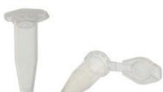
En polypropylène autoclavable, gradué. Sans ADN humain et certifié sans DNase, RNase et inhibiteur de PCR. Sa géométrie et la qualité des matériaux employés permettent une résistance à la centrifugation exceptionnellement élevée : 25.000 g en centrifuge avec rotor d'angle fixe et 70.000 g en centrifuge avec rotor oscillant. Couvercle plat.
