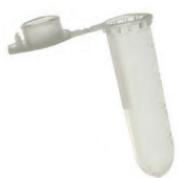
En polypropylène autoclavable.  $\varnothing_{ext}$  10 mm. Avec fermeture de sécurité.
