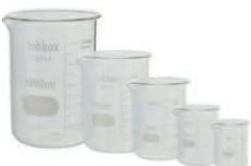
Contient une unité de chacune des 5 capacités suivantes : 50, 100, 250, 500 et 1000 ml. Gradués et avec bec. Fabriqués en verre borosilicaté LBG3.3. Conforme DIN 12331, ISO 3819.
