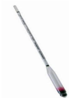
Non normalisé. Lecture en dessous du ménisque. Calibré à 20°C Unité : g/ml. Longueur : 300 mm. N'est pas livré avec certificat d'étalonnage.
