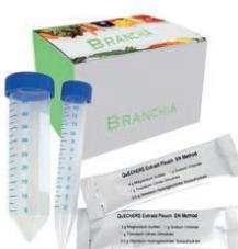
Kits d'extraction et de dispersion pour méthode QUEChERS (Quick, Easy, Cheap, Effective, Rugged and Safe) de préparation d'échantillons pour l'analyse de pesticides multi-résiduels dans les fruits, légumes et autres aliments. Le kit d'extraction (QECH-E10-050) comprend 50 sachets d'extraction (4 g de MgSO<sub>4</sub> + 1 g de NaCl + 1 g de citrate trisodique + 0,5 g de citrate disodique sesquihydraté) et 50 tubes à centrifuger Premium Line de 50 ml. Équivalence : Agilent 5982-5650.
