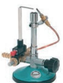
Bunsen avec robinet à vis et stabilisateur de flamme et système d'allumage piézoélectrique. Équipé d'une vanne de sécurité qui interrompt le passage du gaz en cas d'extinction de la flamme. Les vannes de sécurité sont homologuées et se livrent avec certificat de conformité CE selon la directive 2009/142/EC. Bec en laiton nickelé de 11 mm de diamètre x 130 mm de hauteur.
