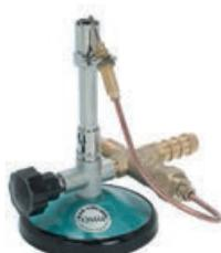
Bunsen avec robinet à vis et stabilisateur de flamme. Équipé d'une vanne de sécurité qui interrompt le passage du gaz en cas d'extinction de la flamme. Les vannes de sécurité sont homologuées et se livrent avec certificat de conformité CE selon la directive 2009/142/EC. Bec en laiton nickelé de 11 mm de diamètre x 130 mm de hauteur.
