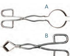
Disponible en deux modèles : pour bêchers de 250 à 1500 ml et pour Erlenmeyers de 100 à 2000 ml. Les deux modèles sont recouverts de liège aux extrémités afin d'améliorer l'isolation.
