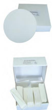
Papier faible en taux de cendre (max 0,06 %) utilisé pour la filtration de particules très fines. Grammage 100 g/m<sup>2</sup>, pore 2- 3 µm, épaisseur 200 µm. Disponible en disque plat et plissé. Équivalence : Whatman 5.
