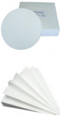
Teneur maximale en cendre 0,06%. Papier composé de fibres longues de coton, utilisé pour la filtration de liquide épais et visqueux. Très épais et résistant offrant le débit le plus rapide des filtres qualitatifs. Grammage 130 g/m<sup>2</sup>, pore 25 - 30 µm et épaisseur 430 µm. Disponible en disque plat et plissé. Équivalence : Whatman 114.
