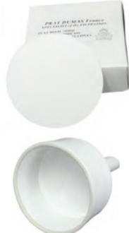
Papier sans cendre (max 0,002%) fabriqué exclusivement avec des fibres en cellulose de coton pure. Utilisé pour analyses gravimétriques de routine. Excellent compromis entre les exigences de vitesse et de rétention. Grammage 80 g/m<sup>2</sup>, pore 8 - 12 µm, épaisseur 270 µm. Disponible en disque plat. Équivalence : Whatman 40.
