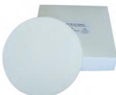
Papier sans cendre (max 0,002%) fabriqué exclusivement avec des fibres en cellulose de coton pure. La vitesse de filtration est rapide ce qui le rend plus adéquat pour la retention de précipités volumineux comme les hydroxydes de fer et nombreux sulfates métalliques. Grammage 80 g/m<sup>2</sup>, pore 10 - 15 µm, épaisseur 250 µm. Disponible en disque plat. Équivalence : Whatman 43.
