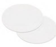
Adéquat pour la préparation d'échantillons en application HPLC. Idéal pour les analyses de routine. Membrane fabriquée en nylon 66 hydrophile.
