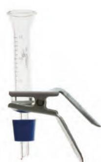
Fabriqué en verre borosilicaté 3.3 de qualité supérieure. Se compose d'une base avec fritté en verre, bouchon en silicone #5 (Ø<sub>sup</sub> 27 mm et Ø<sub>inf</sub> 23 mm), entonnoir et pince en aluminium. À compléter avec la fiole à vide FFE3-100-002.
