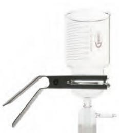
Fabriqué en verre borosilicaté 3.3 de qualité supérieure. Se compose d'une base avec olive à vide, support de filtre en inox recouvert en PTFE, entonnoir et pince en aluminium. À compléter avec une fiole à vide, rodage 40/35.
