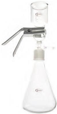
Fabriqué en verre borosilicaté 3.3 de qualité supérieure. Se compose d'une fiole, base avec fritté en verre, entonnoir et pince en aluminium. Le connecteur est conçu pour tube de Ø<sub>int.</sub> 6 mm.
