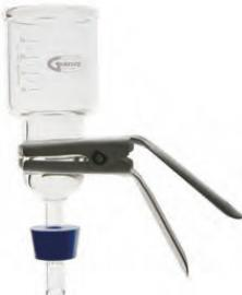
Fabriqué en verre borosilicaté 3.3 de qualité supérieure. Se compose d'une base avec fritté en verre, bouchon en silicone #8 ( $\varnothing_{sup}$  41 mm et  $\varnothing_{inf}$  33 mm), entonnoir et pince en aluminium. À compléter avec la fiole à vide FFE3-1K0-002 ou rampe de filtration.
