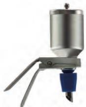
Se compose d'une base, entonnoir (300 ml) et support de filtre en inox, bouchon en silicone #8 ( $\varnothing_{sup}$  41 mm et  $\varnothing_{inf}$  33 mm) et pince en aluminium. Se connecte directement à la rampe de filtration.
