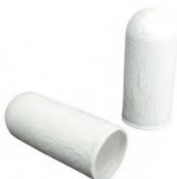
Fabriquée en cellulose de coton pure neutre, sans graisse et sans aucun type de résine agglomérante pouvant provoquer une contamination de l'échantillon.
