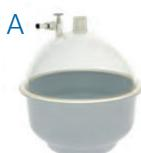
Base en polypropylène et couvercle en polycarbonate transparent. Inclut un panier interne pour le dessiccant (pour modèles de diamètre 200 et 250 mm uniquement). Dispose d'un joint entre la base et le couvercle pour assurer l'étanchéité. Connecteur pour tubes de diamètre intérieur 10 mm (modèles 200 et 250) et 8 mm (modèle 300). Plaque en polypropylène incluse.
