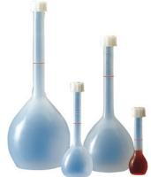
Fabriquée en polypropylène très transparent. Autoclavable. Col étroit et sans ménisque pour une lecture optimale. Calibrée avec une méthode gravimétrique à 20°C.
