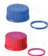
Bouchon et bague anti-goutte en polypropylène bleu, résistants jusqu'à 140°C. Bouchon de PBT rouge avec joint en silicone revêtu de PTFE et bague en ETFE, résistants jusqu'à 200°C.
