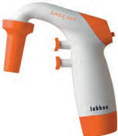
Pour aspirer et distribuer des liquides facilement, efficacement et en toute sécurité. Un filtre en PTFE de 0,2 µm et une valve de sécurité protègent l'entrée des liquides dans le pipeteur. La partie inférieure où se fixent les pipettes peut s'autoclaver à 121°C. Peut s'employer avec des pipettes en verre ou en plastique de 0,1 à 200 ml. Très pratique, de forme ergonomique et maniable d'une seule main. Support pour accrocher au mur et chargeur pour la batterie interne inclus. Garantie 1 an.
