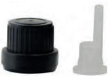
Bouchon à vis en polypropylène avec obturateur compte-gouttes. L'orifice de l'obturateur est de 4 mm de diamètre. Pour les flacons en verre ayant comme références FRGN, FRGA, FRGB et FRGG.
