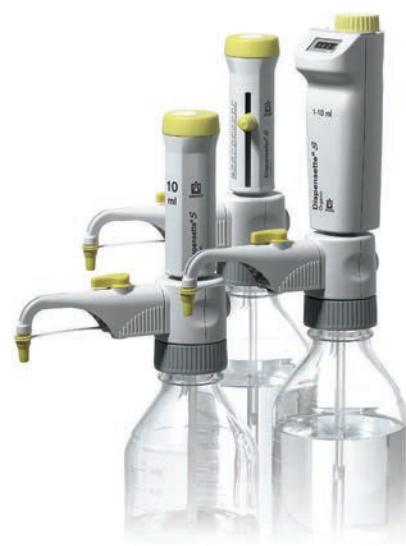
\* Calibrée pour écouler 'Ex'. Les limites d'erreur se réfèrent au volume nominal (= volume max.) imprimé sur l'appareil, la température de l'appareil, la température ambiante et celle de l'eau dist. étant les mêmes (20 °C), l'opération étant régulière et sans à-coups. Les limites d'erreur sont sensiblement inférieures à celles de la norme DIN EN ISO 8655-5. Marquage DE-M.
