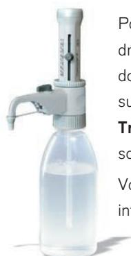
Pour le dosage d'acide fluorhydrique (HF), nous recommandons le distributeur adaptable sur flacon **Dispensette® S**
