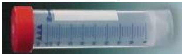
**Désignation commerciale :** Tube à centrifuger 50ml, cape à vis, gradué et aplat, polypropylène, fond conique à jupe, stérile.
