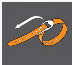
Enclencher le bouton dans un des trous de l'extrémité du garrot pour le fixer en position
