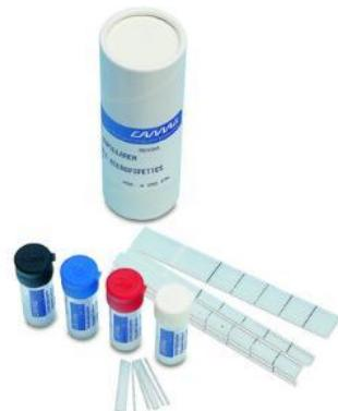
Capillaires en verre jetables pour l'application manuelle des échantillons de 0,5 ; 1 ; 2 ; 5 ou 10 µl. Portatifs et peuvent être positionnés à l'aide du Guide de dépôts multiples pour plaques CCM (551-4230). Peuvent également être utilisés avec le porte-capillaires universel (552-0044). Les micropipettes graduées en verre de 5 µl conviennent à l'analyse qualitative sur les couches TLC conventionnelles.
