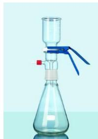
Unité en verre, insert en PTFE et bague, autoclavable
