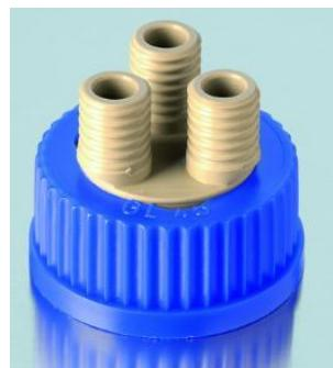
Système de raccord GL 45 avec bouchon à vis en PP et deux ou trois ports en PTFE. Système modulaire flexible. Applications types : transfert de milieux liquides en toute sécurité dans un système stérile et clos (réduction de l'évaporation). Quatre diamètres différents de tuyau (1,6 mm, 3,0 mm, 3,2 mm et 6,0 mm) peuvent être raccordés
