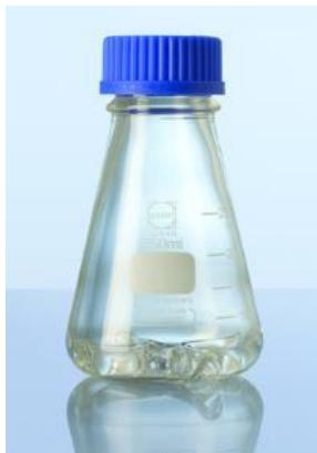
En verre borosilicaté 3.3 transparent DURAN®, sans ou avec bouchon à vis en PP, doté d'une membrane en PTFE.
