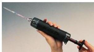
Identification et mesure des gaz spécifiques au moyen d'une pompe d'échantillonnage et de tubes d'analyse.
