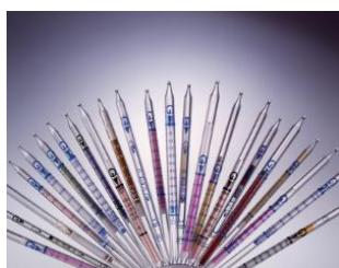
Utilisez la pompe manuelle pour aspirer un échantillon précis de 100 ml d'air par un tube d'analyse spécifique de gaz.
