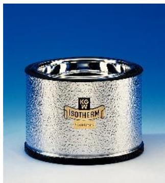
Verre borosilicaté argenté, housse de protection structurée en aluminium.
