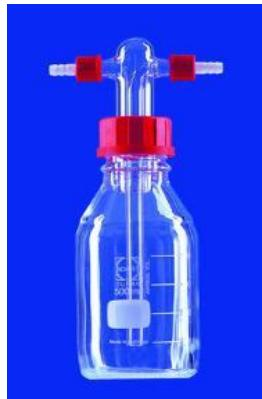
En verre Duran®, transparents, avec bouchons à vis en PBT.
