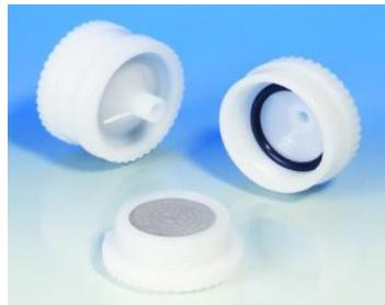
Pour la filtration particulaire de petits volumes (10 à 100 ml) en utilisant une seringue et comme filtre final pour des systèmes de gaz.
