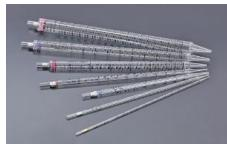
En PS, transparentes, graduées, stériles ou non stériles. Ces pipettes à usage unique conçues pour les transferts de liquides sont fabriquées en GPPS (polystyrène à usage universel) conformément à la norme USP classe VI.
