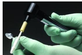
Les pilons et microtubes sont fabriqués à partir de polyéthylène téraphthalate (PBTP) dans une salle blanche M5.5, ISO 7, de classe 10 000. Ils sont conçus pour homogénéiser des cellules et tissus végétaux ou pour remettre en suspension des protéines et des pastilles d'ADN. Un moteur fonctionnant sur batterie, disponible en option, peut être utilisé avec les pilons et les microtubes. Les pilons font 75 mm de long.
