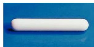
Revêtement en PTFE, noyau magnétique Alnico V. cylindrique possédant une grande force magnétique, surface lisse.
