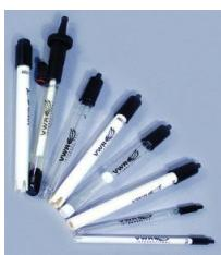
Électrodes de pH avec câble de 1 m fixé ou connecteur S7.
