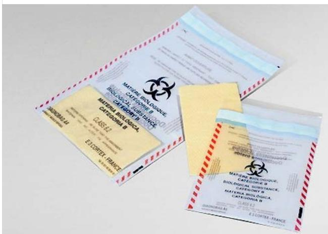
Emballage secondaire utilisé dans le cadre du triple emballage imposé pour toute expédition de matière potentiellement infectieuse de la classe 6.2 Catégorie B (UN3373).
