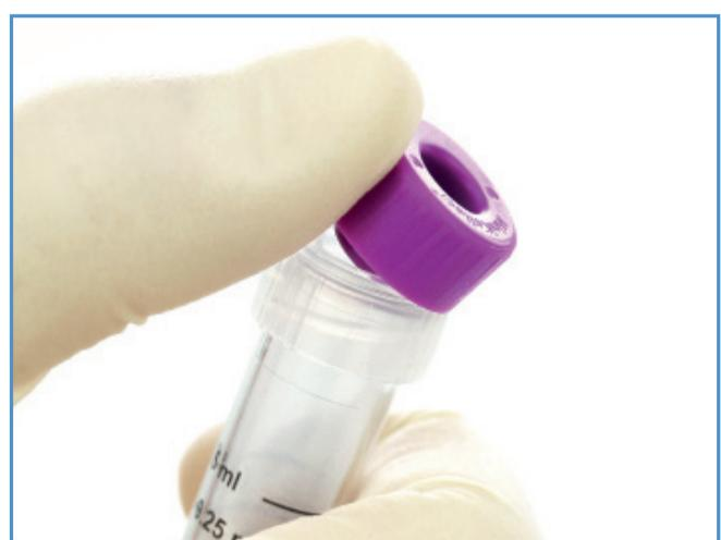
2 La ligne présente au sommet du tube indique la position d'ouverture. Retirer le bouchon du tube en réalisant une légère pression en direction ascendante.
