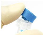
Retirer le bouchon du tube en réalisant une légère pression en direction ascendante. Le triangle indique la position opposée au bec de recueil.
