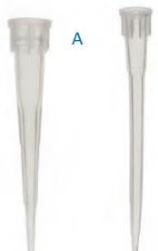
En vrac en sachet refermable. Deux modèles disponibles : type Gilson (compatible avec EASY 40+, Gilson, HTL, Biohit, Finnpipette, Jencons, Genex, Nichiryo, Kartell) et type Eppendorf (compatible avec EASY 40 Elite, Eppendorf, Gilson, Biohit, Brand, Socorex, HTL). Couleur naturelle.
