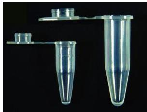
Parois ultrafines pour un transfert thermique optimal
