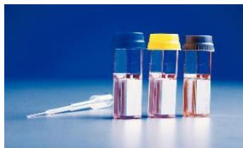
Cuves à usage unique de haute qualité pour la transfection ou la transformation de tous les types de cellules. Disponibles avec trois largeurs de fente : 1,0 mm (pour les cellules bactériennes), 2,0 mm (pour les bactéries et les cellules de plantes ou de mammifères) ou 4,0 mm (cellules de plantes et de mammifères).
