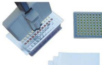
Ces feuilles d'aluminium imperméable particulièrement fines (38 µm d'épaisseur) sont dotées d'un adhésif résistant de qualité médicale qui permet de se passer de tapis ou de thermosoudeuse pour fermer les plaques de PCR. Par rapport aux autres feuilles d'aluminium, ces feuilles ont moins tendance à se recroqueviller sur elles-mêmes lorsqu'on enlève le papier protecteur et s'adaptent bien à la plaque pendant l'application. Le produit stérile est conditionné dans des sacs inviolables de 25.
