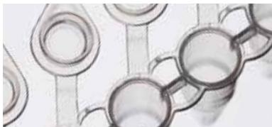
avec les tubes. Les tubes existent en couleur naturel, blanc (pour un meilleur signal) ou mélangés (assortis) pour un code couleur. Les barrettes existent en deux hauteurs : standard (0,2 ml) ou Low Profile (0,1 ml) pour diminuer le volume mort et les effets d'évaporation.
