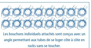
Les bouchons individuels attachés sont conçus avec un angle permettant aux tubes de se loger côté à côté en racks sans se toucher.
