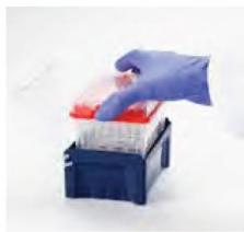
Soulevez la recharge et le couvercle par les ergots de clipsage et placez-les dans le rack vide TipOne® jusqu'à ce qu'ils se clipsent.
