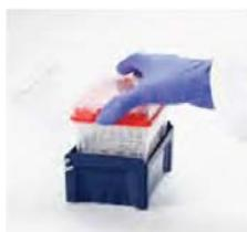
Soulevez la recharge et le couvercle par les ergots de clavage et placez-les dans le rack vide TipOne® jusqu'à ce qu'ils se dispensent.
