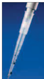
Pointe « low retention » d'un des principaux fabricants avec colorant alimentaire vert
