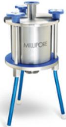
**Procédure TCLP (Toxicity Characteristic Leaching Procedure) et test de toxicité conformément aux réglementations de l'EPA américaine**
