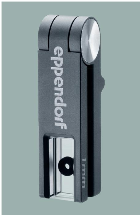
La µCuvette G1.0, avec un trajet optique de seulement 1 mm, fournit un faisceau lumineux 10 fois plus court que celui des cuves standard. La µCuvette G1.0 permet ainsi de mesurer de hautes concentrations d'acide nucléique et de protéines. Vous pouvez réaliser une mesure avec seulement 1,5 µL d'échantillon. La µCuvette G1.0 étend ainsi la versatilité des domaines d'application photométrique de tous nos appareils de détection en cuves.
