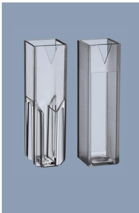
La cuvette Vis Eppendorf à usage unique est fabriquée en polymère transparent et peut être utilisée de 300 nm à 900 nm.
