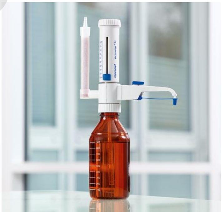
Les acides fumants fréquemment utilisés dans l'industrie chimique doivent être protégés de l'humidité. Le tube de dessiccation rempli d'absorbeur d'humidité protège le liquide.
