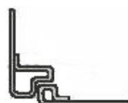
Le procédé de **profilage agrafage** **Seamlime®** renforce la résistance des montants, équivalent à une tôle ép. 10/10<sup>ème</sup> pliée.
